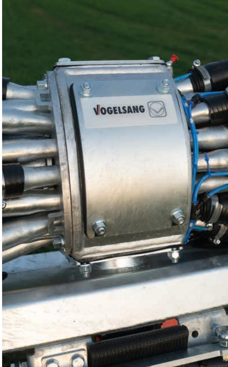
Ähnlich wie sein großer Bruder, der ExaCut ECC, kommt auch dieser Verteiler ohne Luftnachsaugung aus. Es gab allerdings noch keinen Verteiler, der so kompakt konstruiert wurde, wie der ExaCut ECM. Dies ermöglicht ein Schneidprinzip, das dem RotaCut angelehnt ist. Ein Rotordesign, das zu keiner Zeit einzelne Löcher im Schneidsieb komplett abschließt führt zum gleichmäßigen Medienstrom ohne Pulsation.
