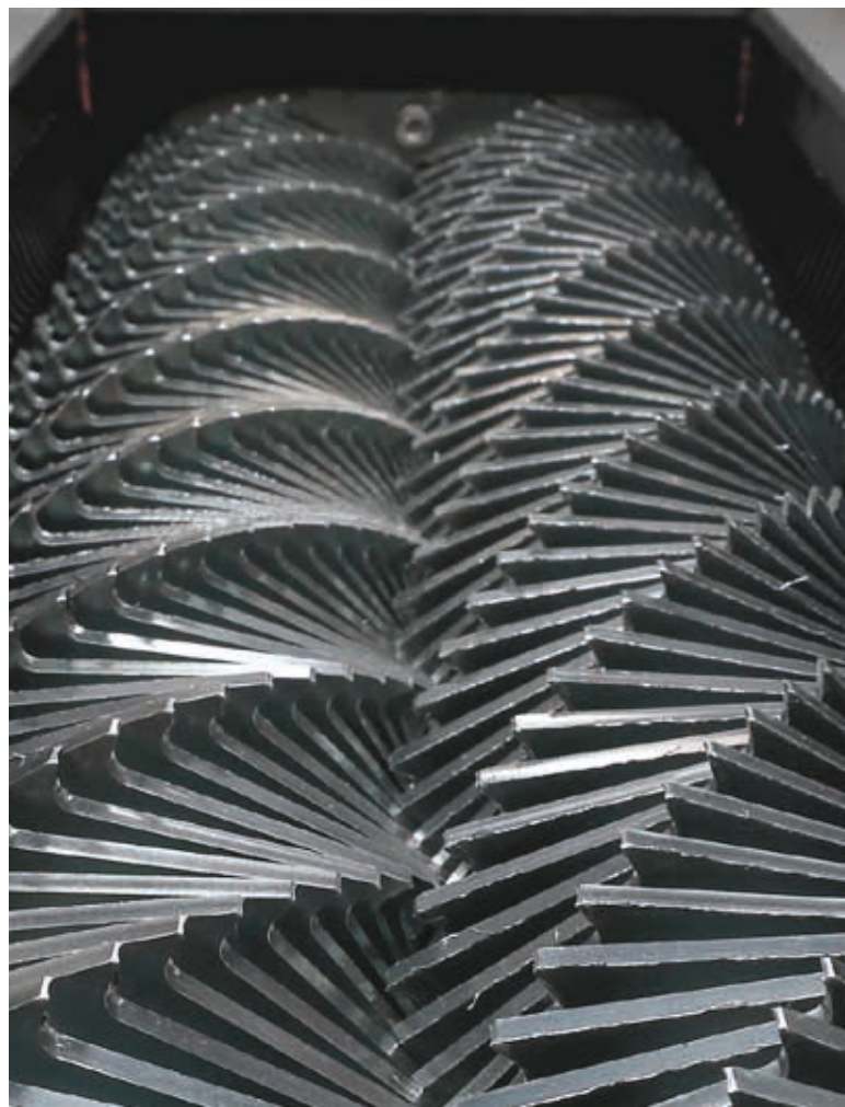
Die monolithischen One-Piece Ripper-Rotoren sind extrem biegesteif und besonders einfach in der Wartung
